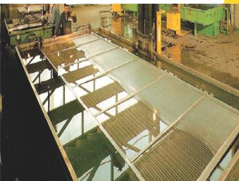
Diferentes materiales de tubo se utilizan para la construcción de las baterías de intercambio térmico, son expansionados, curvados, soldados y probada su estanqueidad a las presiones más extremas de funcionamiento con los sistemas más avanzados en la fabricación de baterías aleteadas.
