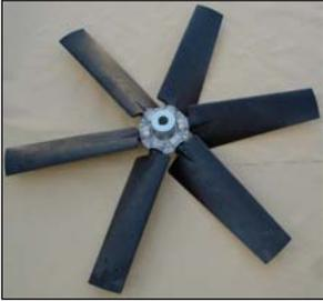
Ventilador de tipo axial de gran diámetro formado por una hélice de múltiples palas en polipropileno reforzado con fibra de vidrio o en aluminio con perfil alar, fijadas a un núcleo de aleación de aluminio. Éstos ventiladores van **directamente acoplados** a motores estándar
